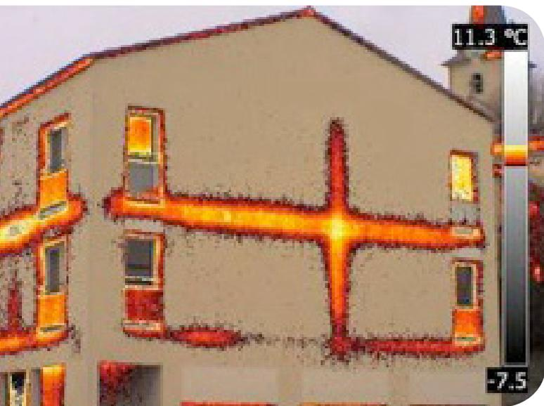
Ilustración 3. Puentes térmicos en un edificio
