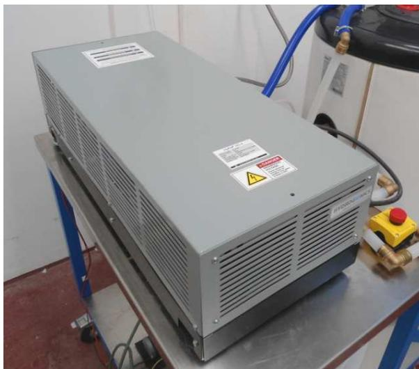
**Ilustración 48. Pila de combustible de hidrógeno, marca Hydrogenics**
