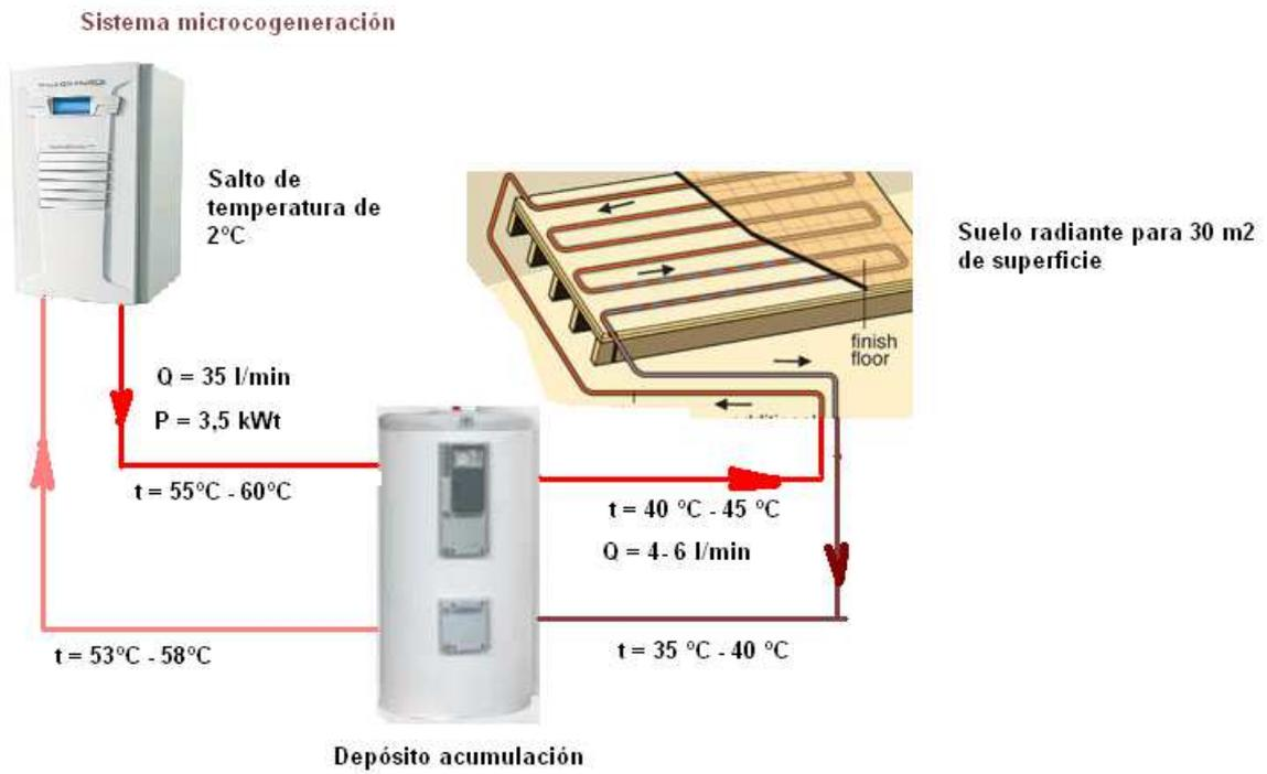
Ilustración 61. Diagrama del sistema de cogeneración – suelo radiante
