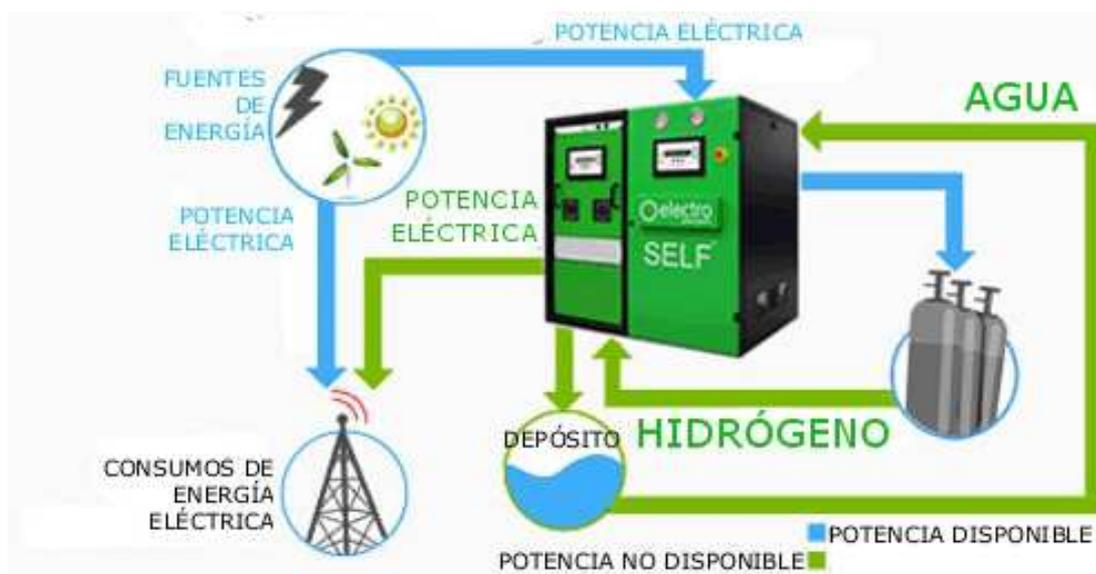
**Ilustración 10. Funcionamiento del sistema Electro Power System Electroself**
