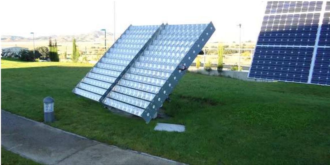
**Ilustración 13: Seguidor solar de concentración**
