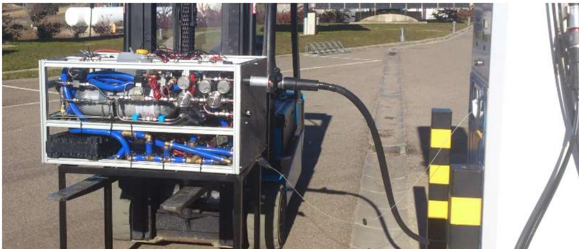
**Ilustración 16. Recarga del power pack de la carretilla de hidrogeno.**
