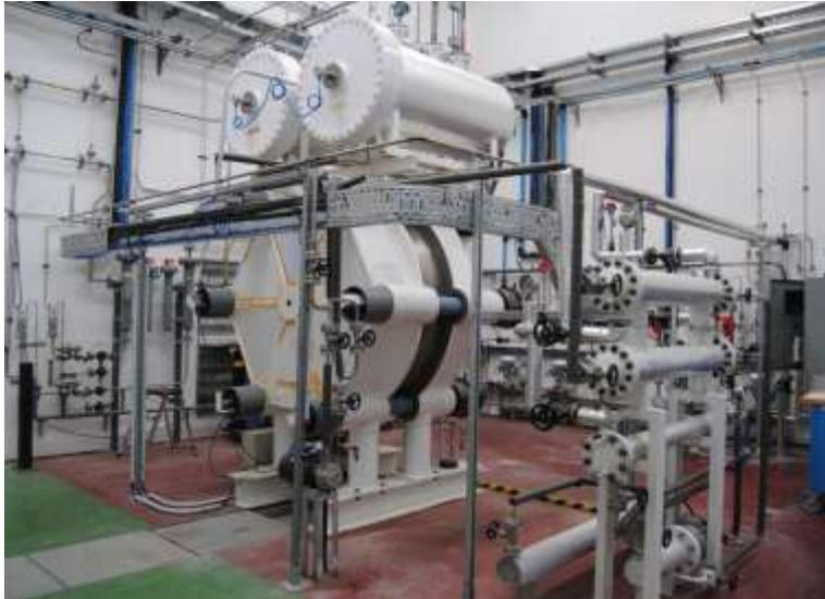
**Ilustración 8. Electrolizador instalado en la Fundación Hidrogeno Aragón.**
