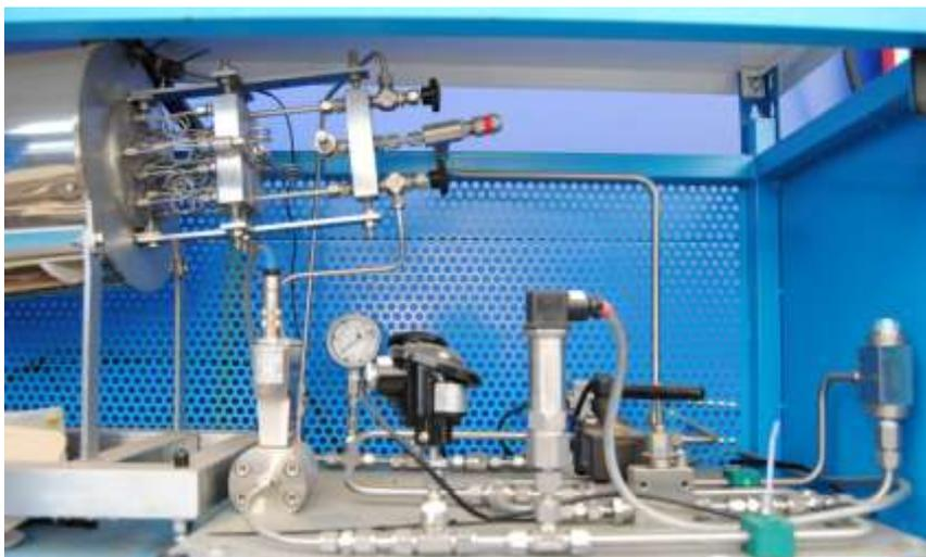
**Ilustración 9. Sistema de compresión basado en hidruros metálicos (Comuro).**
