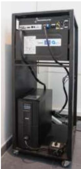
**Ilustración 19. SAI con pila de combustible de hidrogeno**
