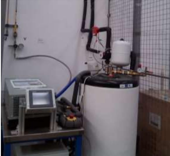
**Ilustración 18. Banco de ensayos de la pila de cogeneración.**
