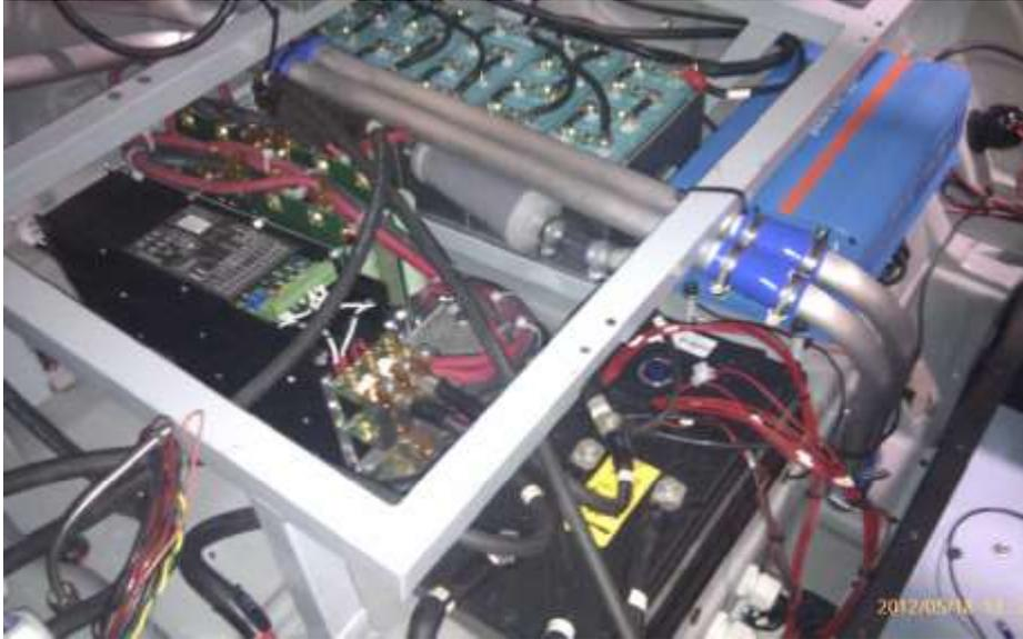
**Ilustración 10. Electrónica de potencia del prototipo de FCEV (Fuel Cell Electric Vehicle).**
