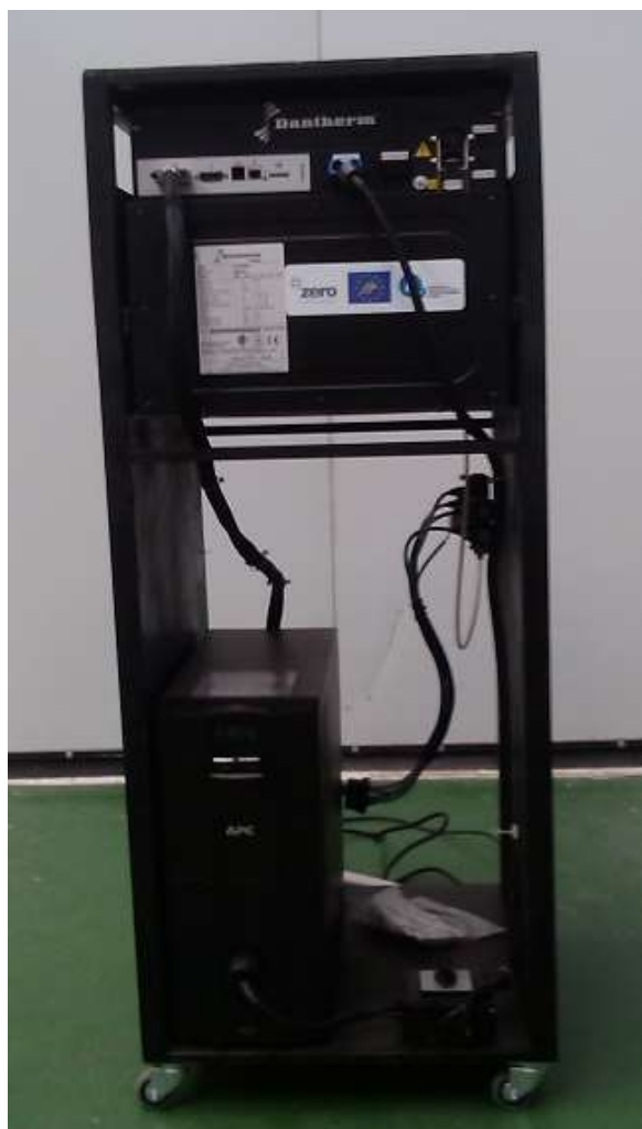
Figura 10. Imagen del sistema SAI de hidrógeno.
