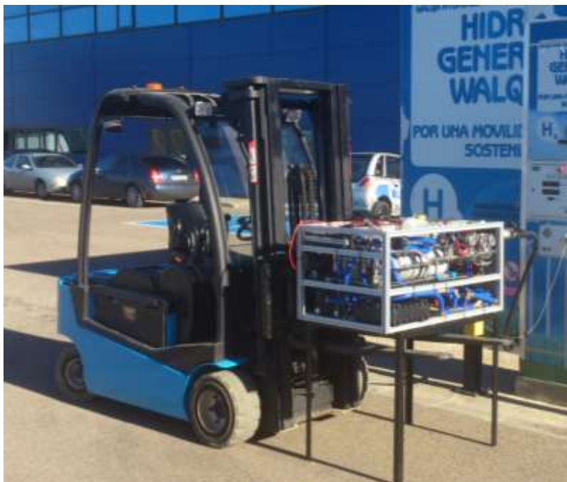
Figura 15. Carretilla elevadora con el sistema de propulsión de hidrógeno.
