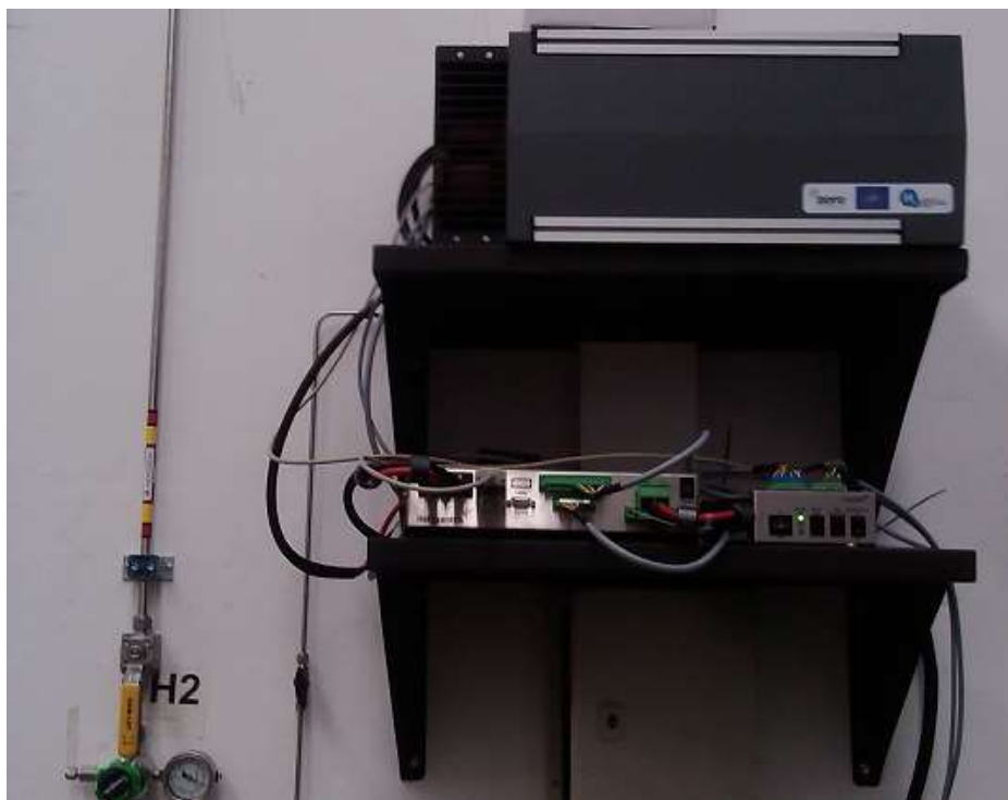
Figura 7. Pila de combustible de hidrógeno de 1,2 kW.
