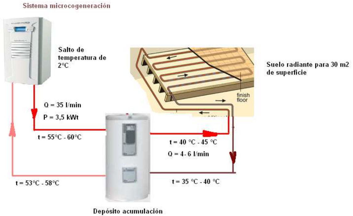
Ilustración 61. Diagrama del sistema de cogeneración – suelo radiante
