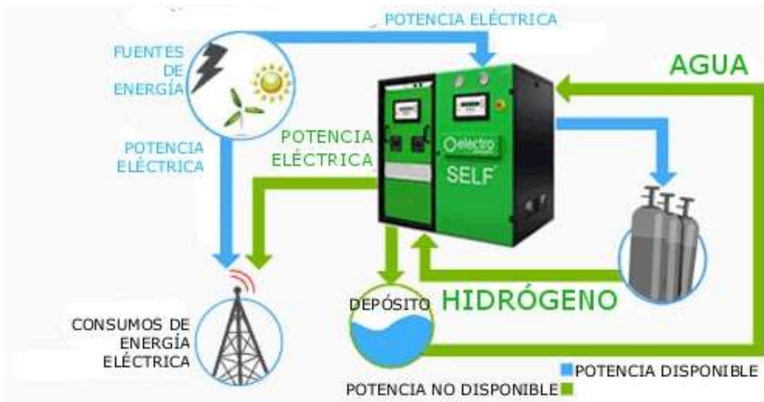
Ilustración 10. Funcionamiento del sistema Electro Power System Electroself
