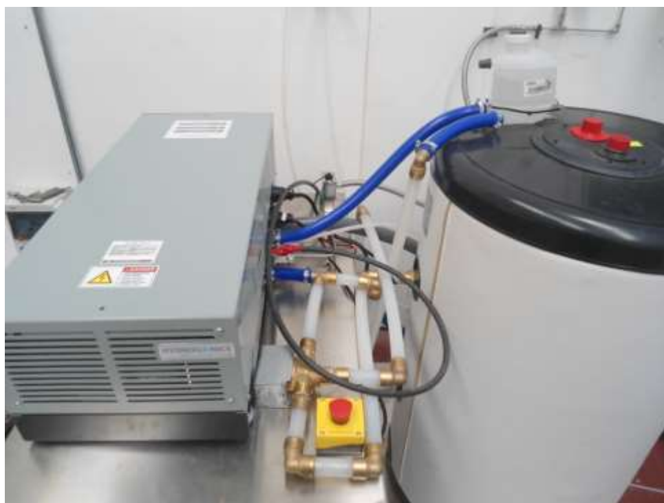
Ilustración 50. Circuito de refrigeración de la pila de combustible
