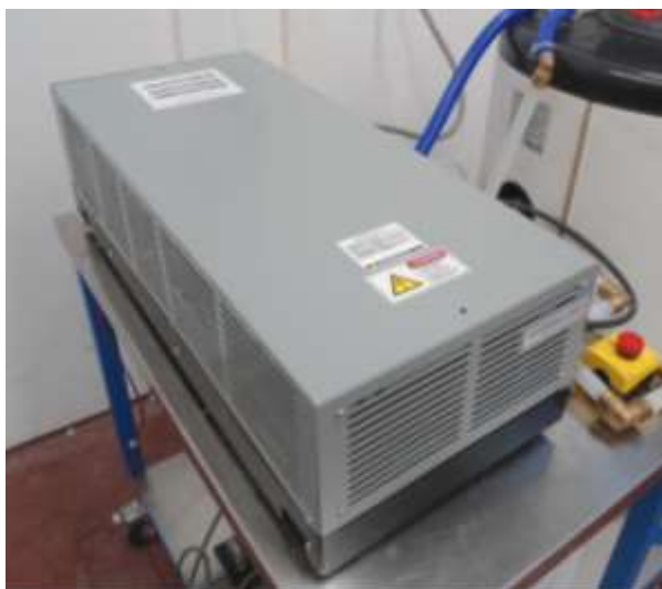
Ilustración 48. Pila de combustible de hidrógeno, marca Hydrogenics
