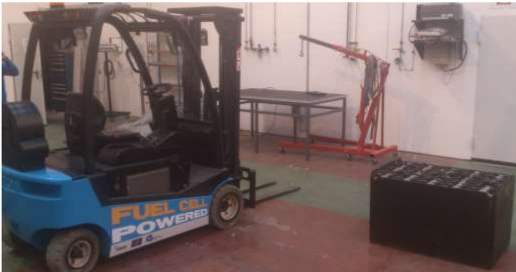
**Figura 23. Carretilla de pila de combustible de hidrogeno.**
