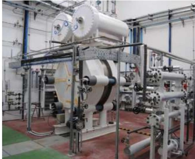
Figura 15. Electrolizar alcalino.
