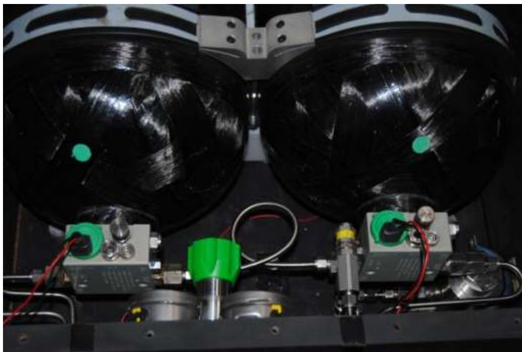
Figura 6. Circuito de alimentación de hidrogeno del vehículo de pila de combustibles de hidrógeno.
