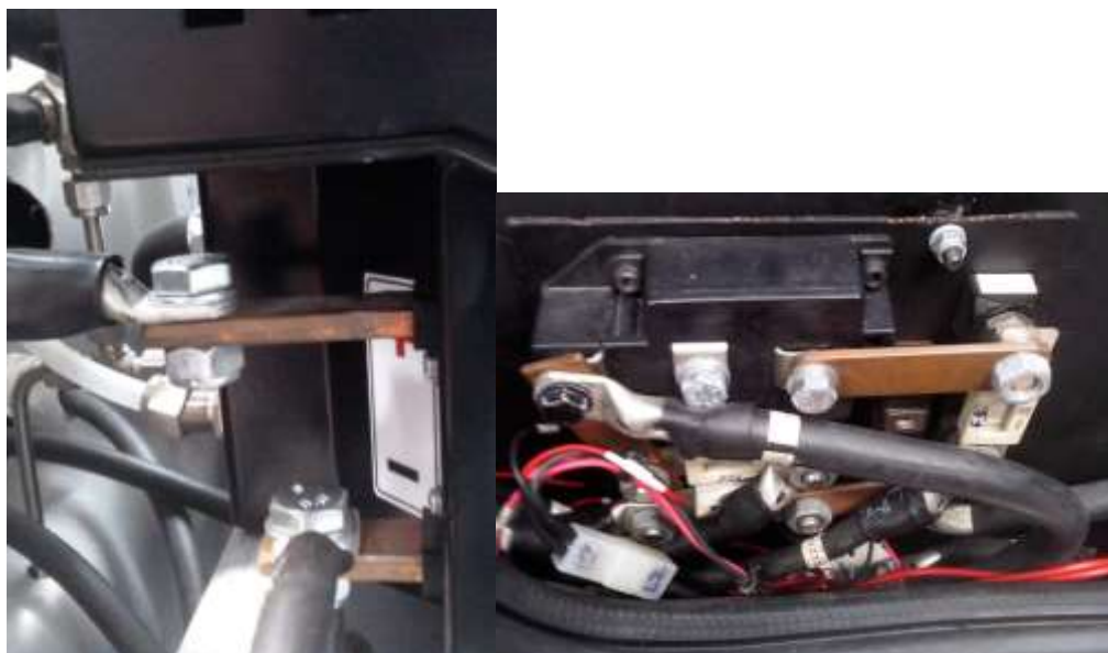
Figura 19 Protección conexiones de potencia.
