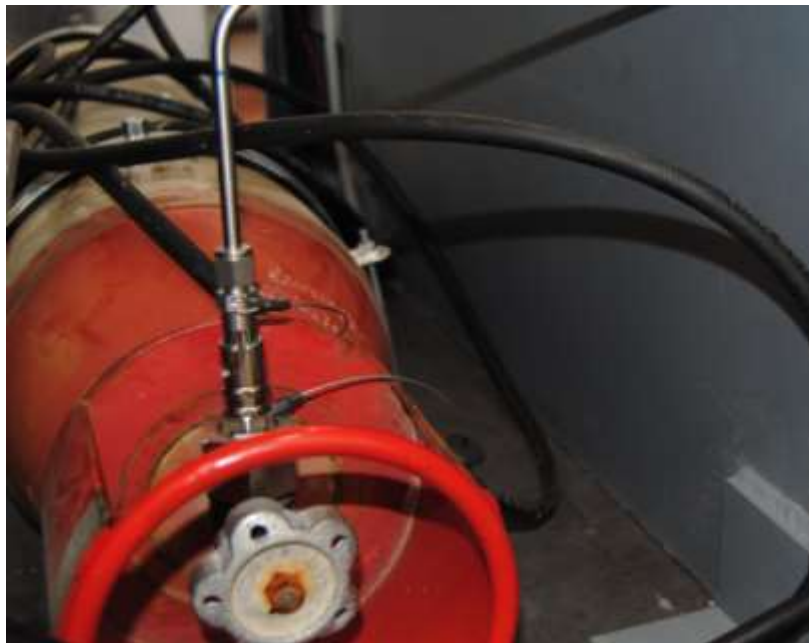
Figura 31. Conexión rápida en la botella de hidrógeno.
