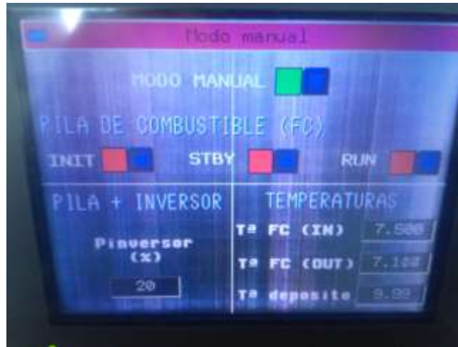
Figura 28. Control del modo manual de la pila donde se puede encender y apagar la pila, así como elegir la potencia que entrega al inversor.
