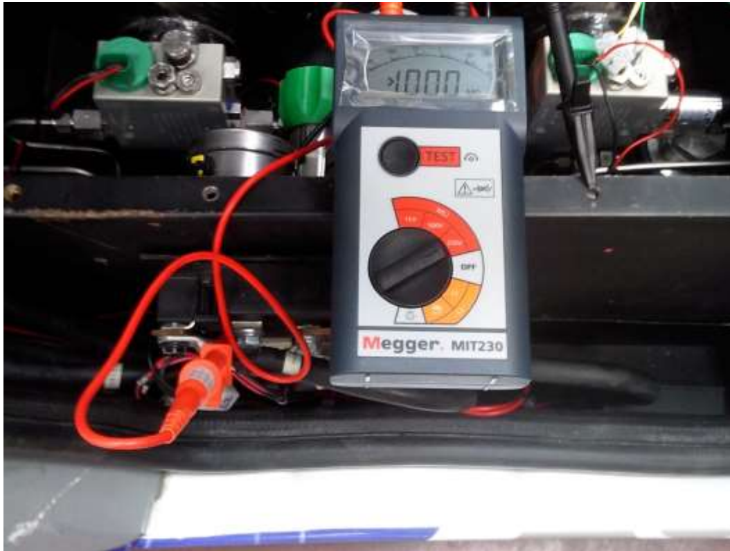
Figura 14. Resistencia entre chasis y bus DC.
